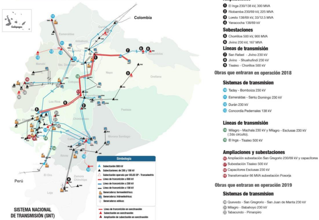
Figura 7.11 - Proyectos de Expansión del SNT en ejecución
