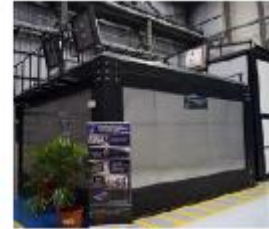
HORNO ELÉCTRICO DE TRATAMIENTO TÉRMICO
