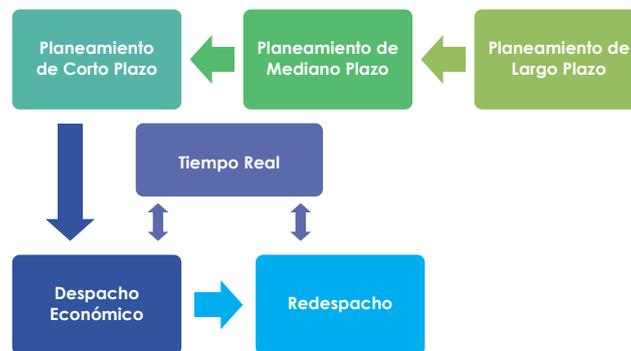
Figura 9: Proceso de Programación de operación de la Central
