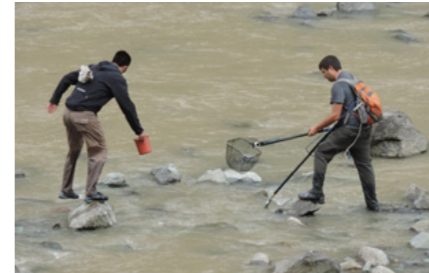
Fotografía 3.- Método de electrofishing en el cuenco amortiguador.
