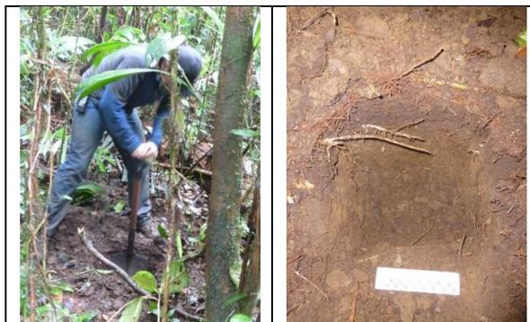
Foto 61 y 62: Excavación de prueba de pala
