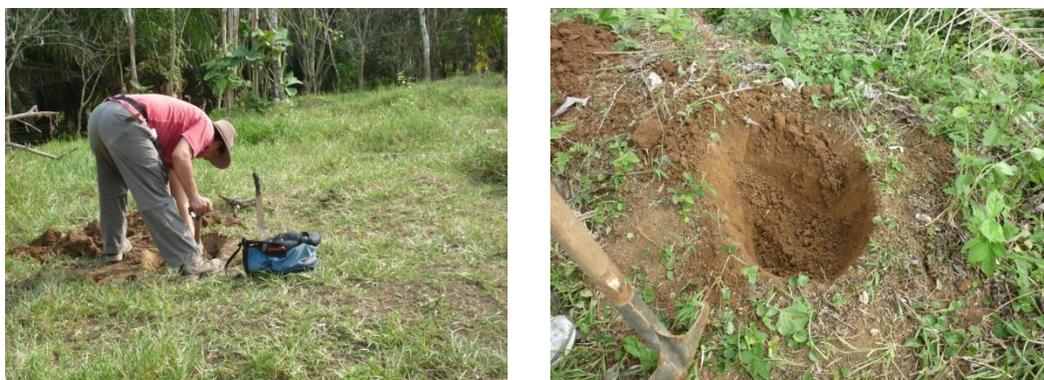
**Figura 4-24 Pruebas de pala. Non sitio Subestación Quinindé**
