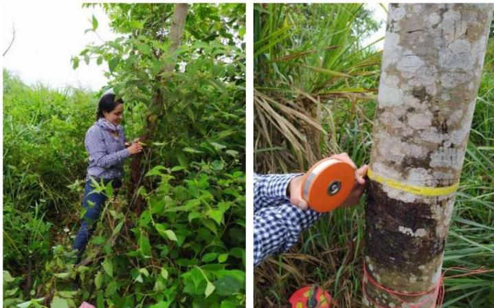
**Figura. Medición de diámetro a la altura del pecho en árboles mayor a 10 cm de DAP.**
