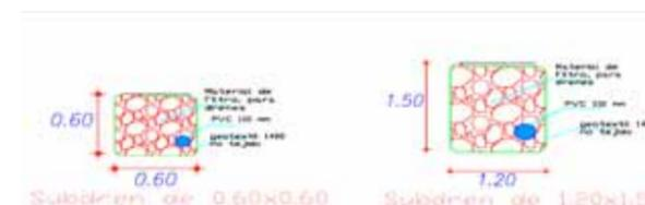
Figuras 5 y 6. Dimensiones de las secciones del sistema de drenaje subterráneo. F5 subdren de 0,60 m x 0,60 m; F6 subdren de 1,20 m x 1,50 m (Diseño: Oscar Acosta. Plano: Luis Castro)
