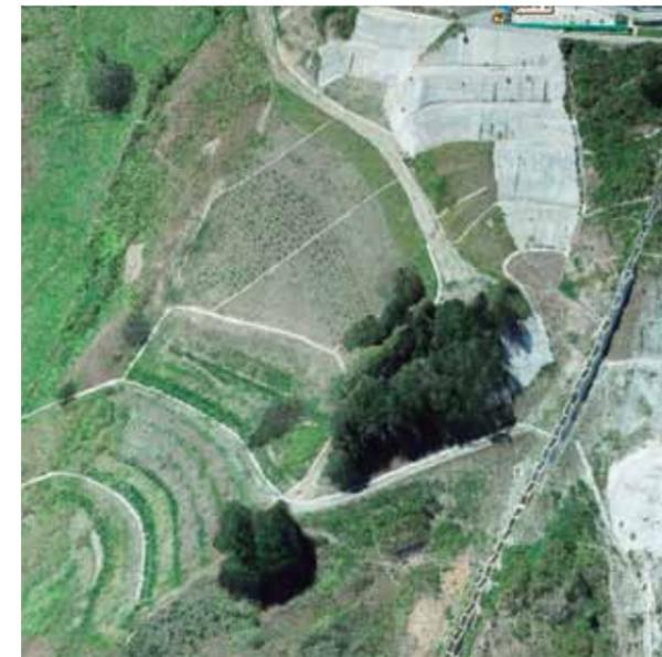
Figura 9. Escombrera 1 implantada en el sector del Tanque de Carga - Central San Antonio. Se visualiza el área revegetada con el sistema de drenaje superficial. Proceso de Cierre. (Captura con dron: Manuel Cuenca)
