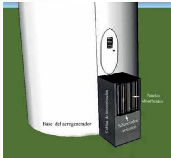
Figura 8: Modelo virtual de cabina de insonorización. Fuente: Torres (2017)
